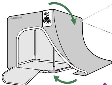
2a. Despliegue toda la Tela de la carpa y abra completamente el cierre principal. Comience a montar la Tela sobre la estructura, empezando por el lado derecho y luego por el izquierdo.
