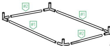
1a. Una cuatro Conectores de Esquinas con dos Barras #1 y dos Barras #2, asegurándose que queden bien encajadas. Repita el proceso para obtener dos bases, una será la Base Piso y la otra la Base Techo.
