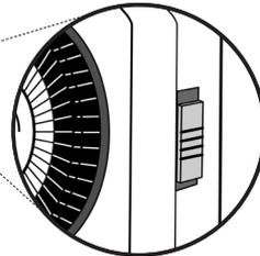
3b. Ajuste la hora del Timer girando la rueda hasta que el triángulo pequeño quede alineado con la hora actual.
