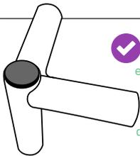
✓ Asegúrese que las esquinas metálicas queden todas con el tope negro apuntando en la misma dirección. En la Base Piso los topes deben tocar el suelo y en la Base Techo deben apuntar hacia el techo.
