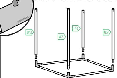
1c. Base Piso: Conecte en cada esquina de la base una Barra #3, como indica la figura.
