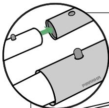
1b. Conecte en cada esquina de las Base Techo una Barra #3, como indica la figura. Luego conecte la Base Piso a la estructura.
