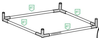
1a. Una cuatro Conectores de Esquinas con las cuatro Barras #1, asegurándose que queden bien encajadas. Repita el proceso para obtener dos bases, una será la Base Piso y la otra la Base Techo.
