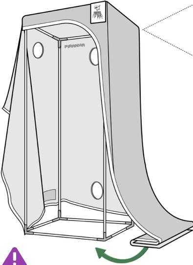
**3a.** Despliegue toda la Tela de la carpa y abra completamente el cierre principal. Comience a montar la Tela sobre la estructura, empezando por el techo y luego por las paredes.
