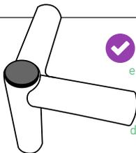
✓ Asegúrese que las esquinas metálicas queden todas con el tope negro apuntando en la misma dirección. En la Base Piso los toques deben tocar el suelo y en la Base Techo deben apuntar hacia el techo.
